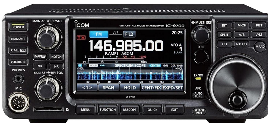
Fot. W.1. Trzypasmowa radiostacja IC-9700 pokrywa zakresy 2 m, 70 cm i 23 cm i pozwala na pracę wszystkimi emisjami z D-Starem włącznie
