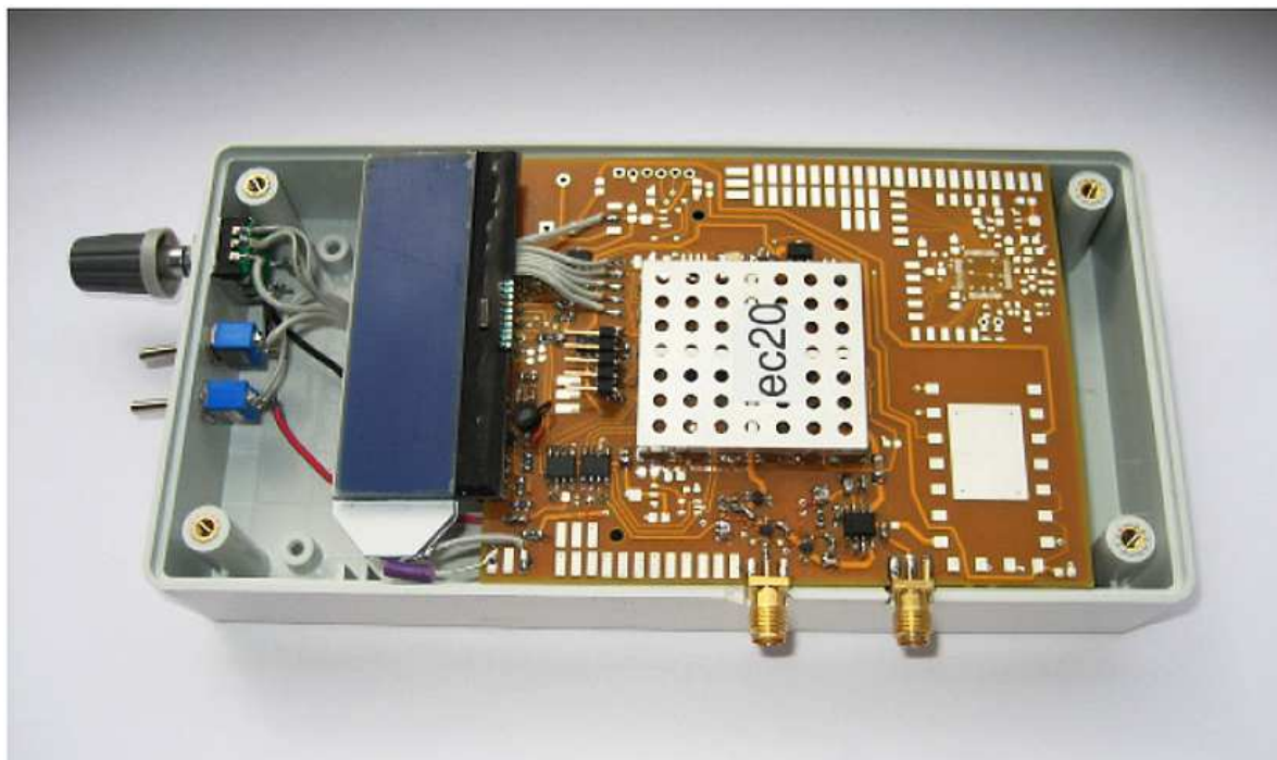
Fot. 4.7. Konstrukcja wewnętrzna wersji 4-pasmowej. Po prawej stronie u dołu miejsce dla modułu DRA818V
