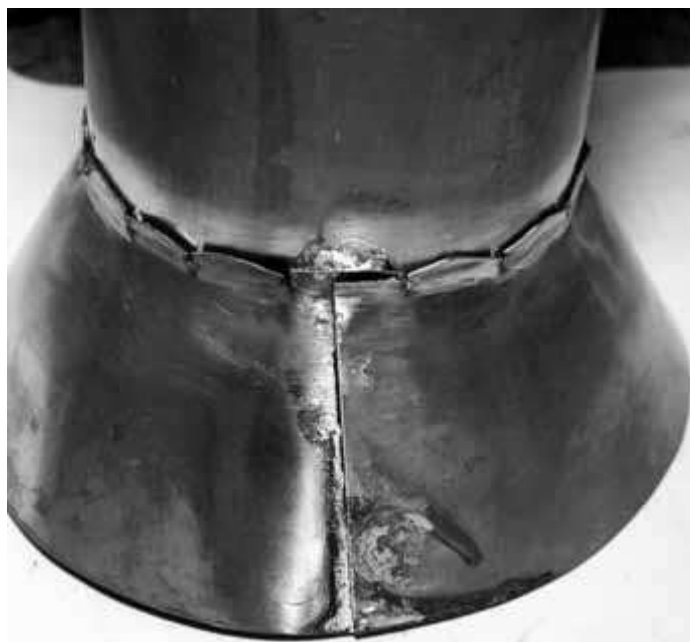
Rys. 7.6 d. Miejsca lutowania języzków kontaktowych do tuby
