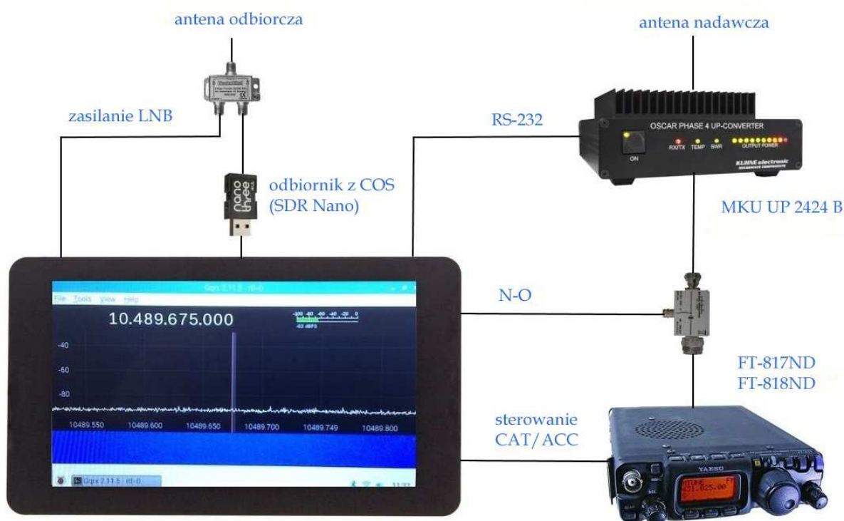
Rys. 2.19. Stacja do pracy przez geostacjonarnego satelitę „EsHail-2” (QO-100). Zamiast konwertera nadawczego MKU UP 2424 B można użyć transwertera ze wzmacniaczem mocy (patrz tab. 2.5). Siła odbioru własnego sygnału nie powinna przekraczać siły odbioru radiolatarni satelity nadających na krańcach pasma. Częstotliwość pracy musi leżeć pomiędzy tymi oficjalnymi krańcami. Zamiast odbiornika programowalnego „SDR Nano” może być zastosowany dowolny inny odbiornik tego rodzaju. Jako komputer sterujący może służyć nawet „Malina” z ekranem dotykowym i oprogramowaniem obsługującym odbiornik
