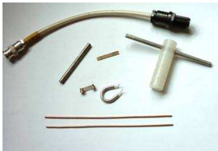
Fot. 7.18. Elementy konstrukcyjne anteny
