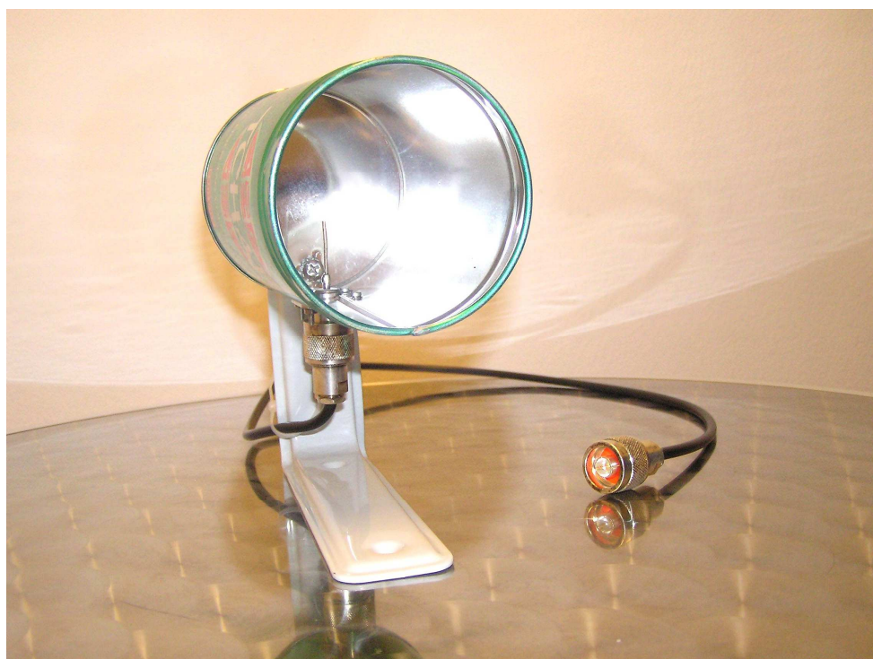
Rys. 7.5. Antena puszkowa OE1KDA na pasmo 13 cm. Antenka pobudzająca jest wykonana z przewodu miedzianego posrebrzanego.
