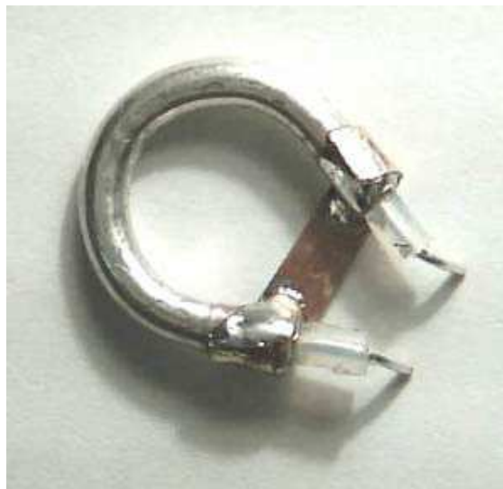
Fot. 7.17 Wykonanie symetryzatora
