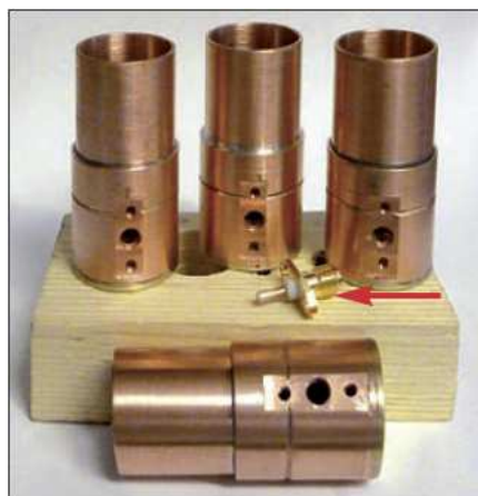
Fot. 8.14. Wykonanie promiennika na 10 GHz. Na zdjęciu 4 egzemplarze i gniazdko SMA z przylutowaną antenką
