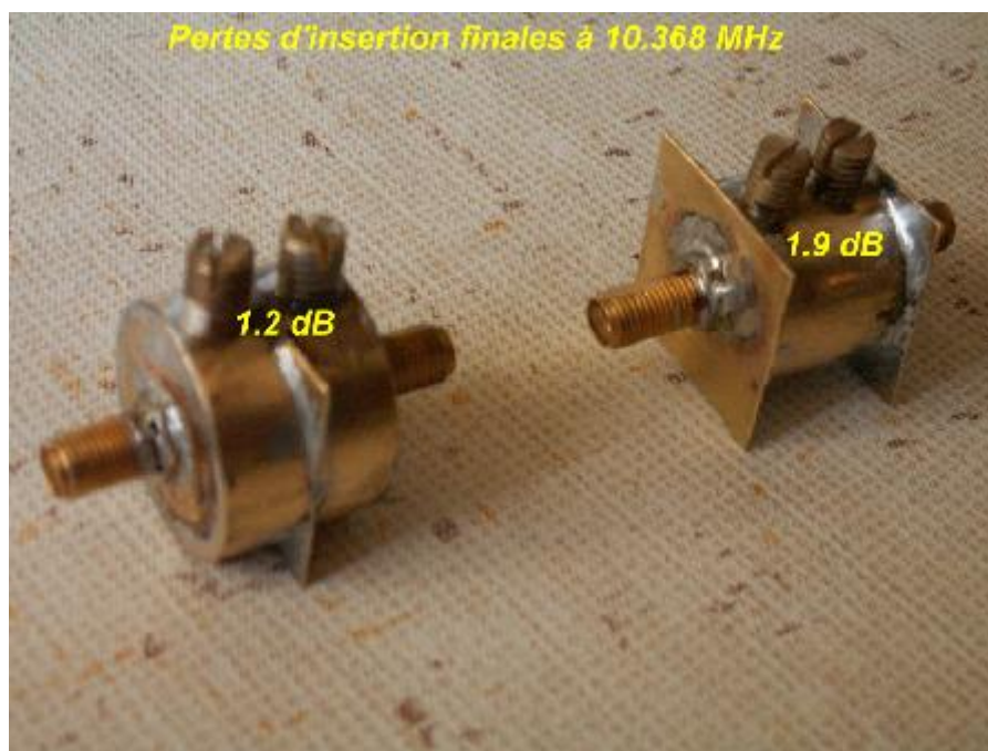
Fot. 9.11. Wygląd gotowego filtru (po prawej stronie)
