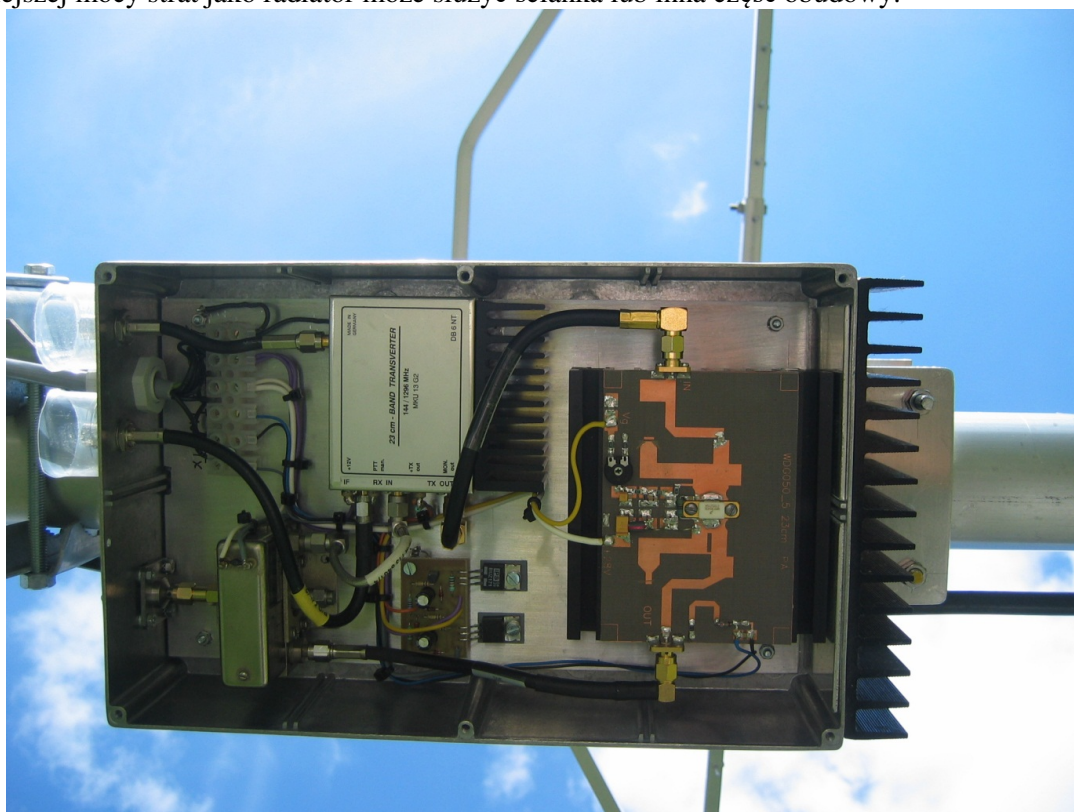
Fot. 2.16. Przykład konstrukcji transwertera umieszczonego w pobliżu anteny. U góry widoczny jest moduł transwertera MKU 13 G2, pod nim przełącznik sekwencyjny a po jego lewej stronie – przełącznik antenowy. Znaczną część obudowy po prawej stronie zajmuje wzmacniacz mocy. Całość zamknięta jest w odlewanej obudowie aluminiowej. Połączenia w.cz. wykonano za pomocą półsztywnego kabla („semiflex”) zakończonych wtyczkami SMA. Wprawdzie zalecane jest unikanie wtyków kątowych ale nie zawsze da się tego przestrzegać. Do połączeń można użyć również sztywnego kabla UT141, ale nie jest to konieczne
