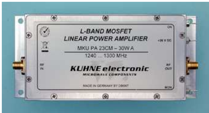
Fot. 2.15. Wzmacniacz o mocy 40 W. Do połączenia z transwerterami MKU 13 konieczne jest zastosowanie tłumika redukującego moc wyjściową transwertera z 2,5 W do 1 W. Wzmacniacz musi być umieszczony na odpowiednim radiatorze. Producent zaleca radiator SK 150-62 (dostępny m.in. w firmie „Conrad”) z wentylatorkiem. Oporność cieplna podanego radiatora wynosi 0,21 °K/W przy szybkości przepływu powietrza 5 m/s.
