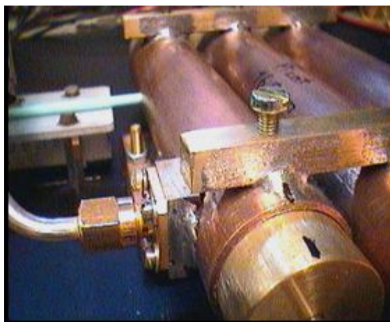
Fot. 9.7. Widok z boku. Dobrze widoczne podkładki służące do zamontowania gniazdek i poprzeczne płaskowniki, do których wkręcane są śruby mocujące zwieracze
