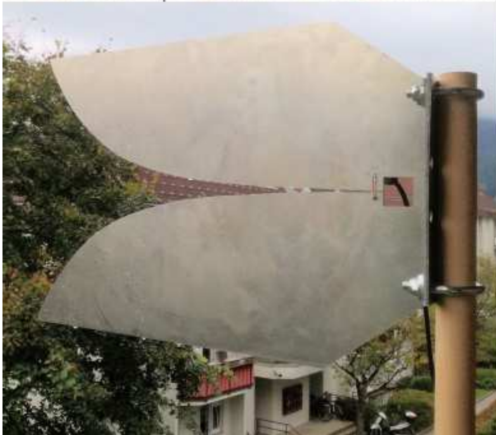
Fot. 7.29. Antena konstrukcji OE7WPA (widok z obydwu stron)
